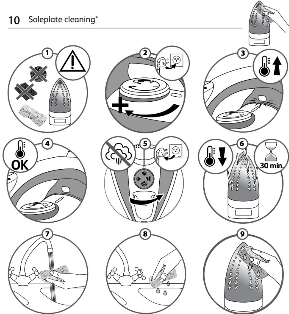
\*DE Reinigung der Bügelsohle • FR Nettoyage de la semelle • NL Reinigen van de strijkzool
